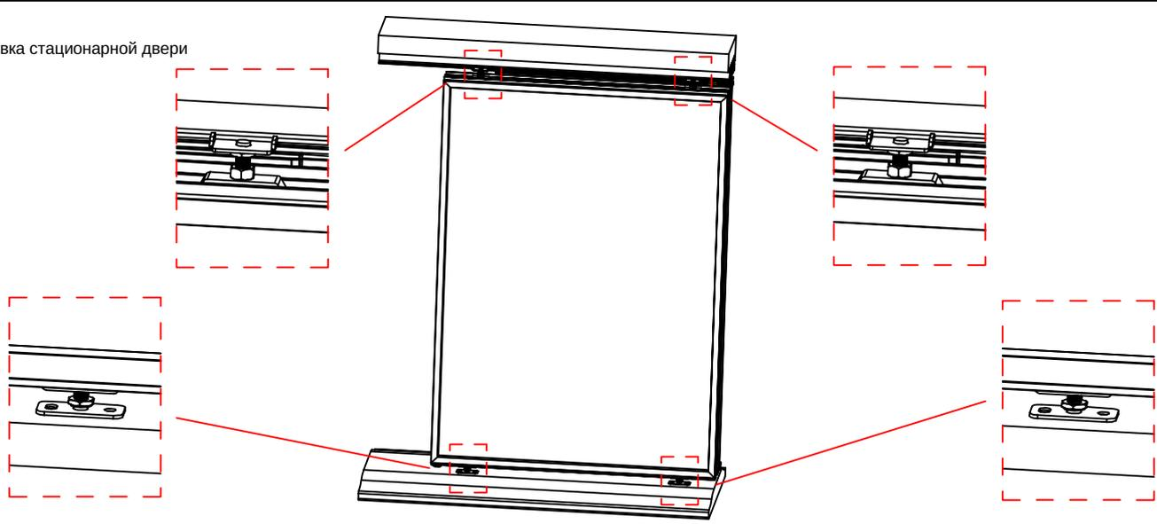
7. В соответствии со схемой отрегулируйте соединенное дверное полотно А и дверное полотно В соответственно, чтобы добиться эффекта зубчатого ремня:
