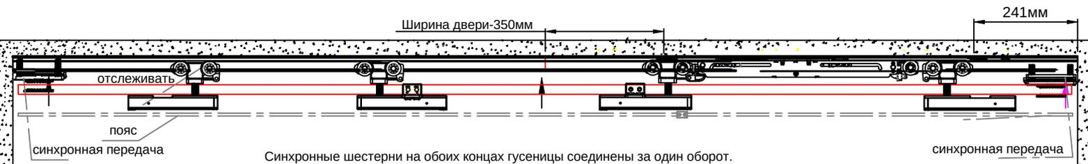
5. Установите нижнее направляющее колесо под дверную раму согласно рисунку, а затем соедините полотно А и В с подвесным колесом в сборе и доводчиком
